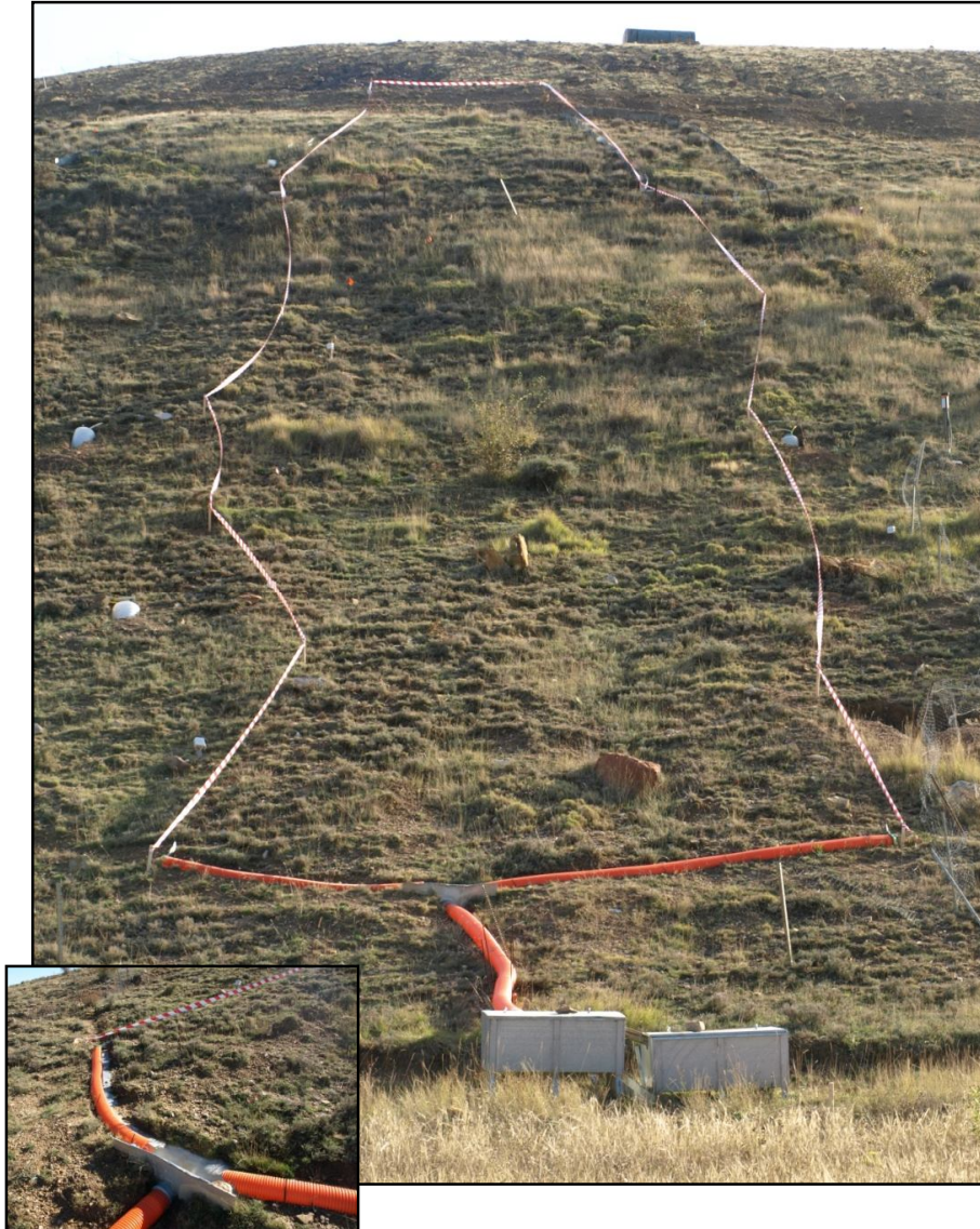
Figura 3. Parcela de escorrentía instalada en la ladera 2, con manchas Brachypodium en zonas de derramaderos de escorrentía y detalle de colector a pie de ladera.
