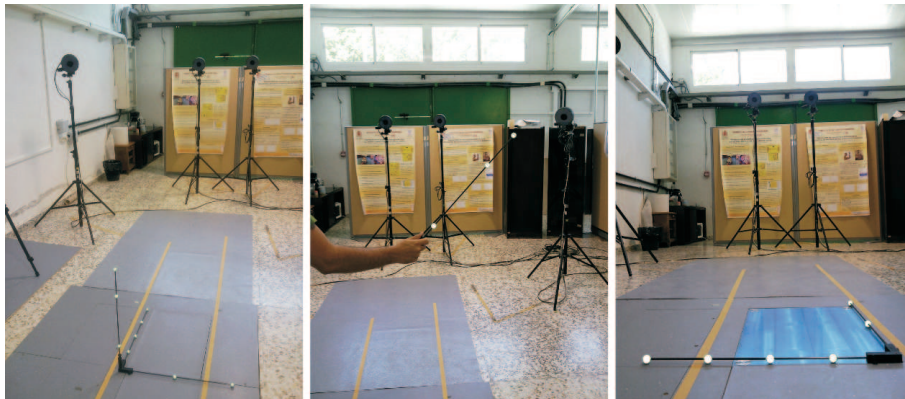
Figura 3.3: Proceso de calibración del sistema de análisis de movimiento.
