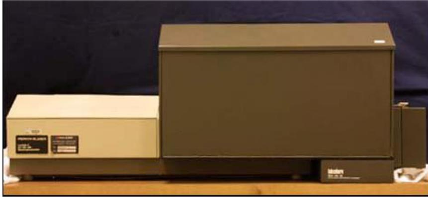
Figura 10: Ejemplo de un espectrofotómetro. Perkin-Elmer Lambda-19. Capacidad espectral 250-2500 nm con un rango de 1,00 nm ([www.grc.nasa.gov/WWW/epbranch/OpticalProps/lambda.htm](http://www.grc.nasa.gov/WWW/epbranch/OpticalProps/lambda.htm))
