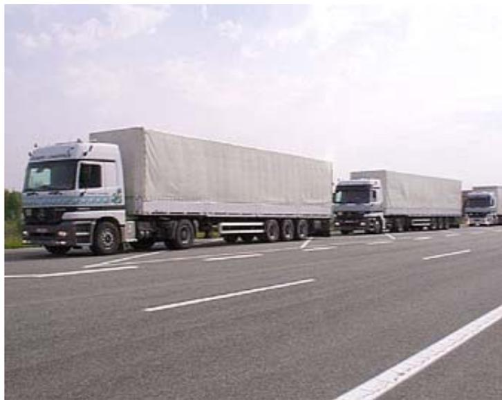
Figura 2.13: Demostración de la maniobra de platooning en el proyecto CHAUFFEUR-2.
