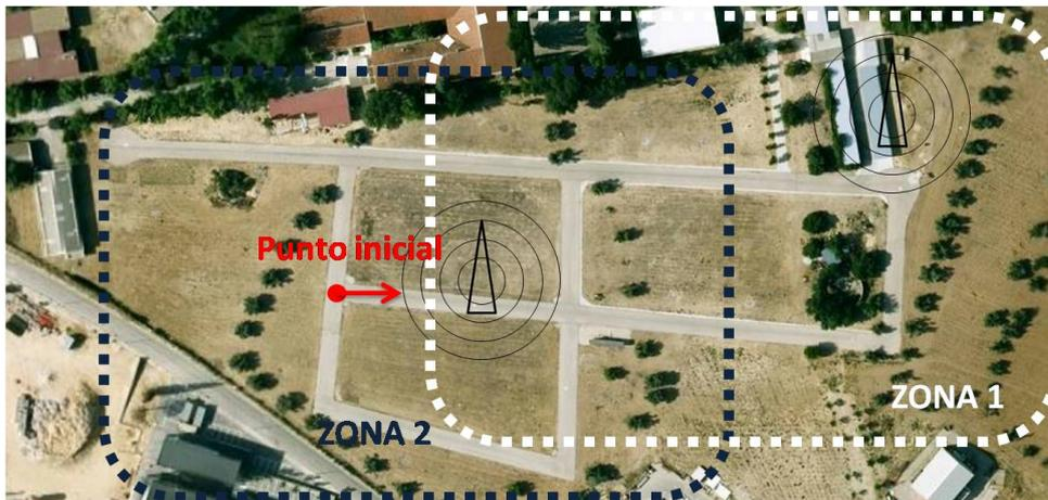
Figura 3.7: Zona experimental y ubicación de las estaciones locales de control para validar la arquitectura propuesta.
