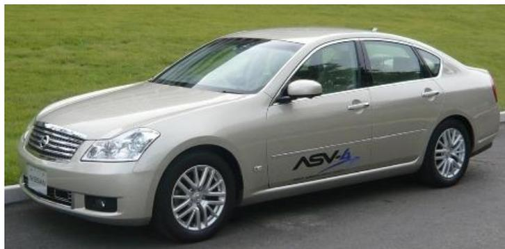
Figura 2.11: Nissan ASV-4 para la reducción de accidentes basado en comunicaciones vehículo-vehículo.
