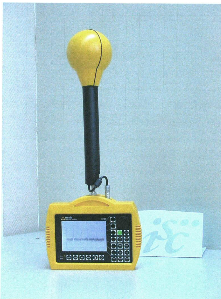
Figura 4.6. Medidor selectivo de emisiones radioeléctricas SRM-3000, de Narda STS
