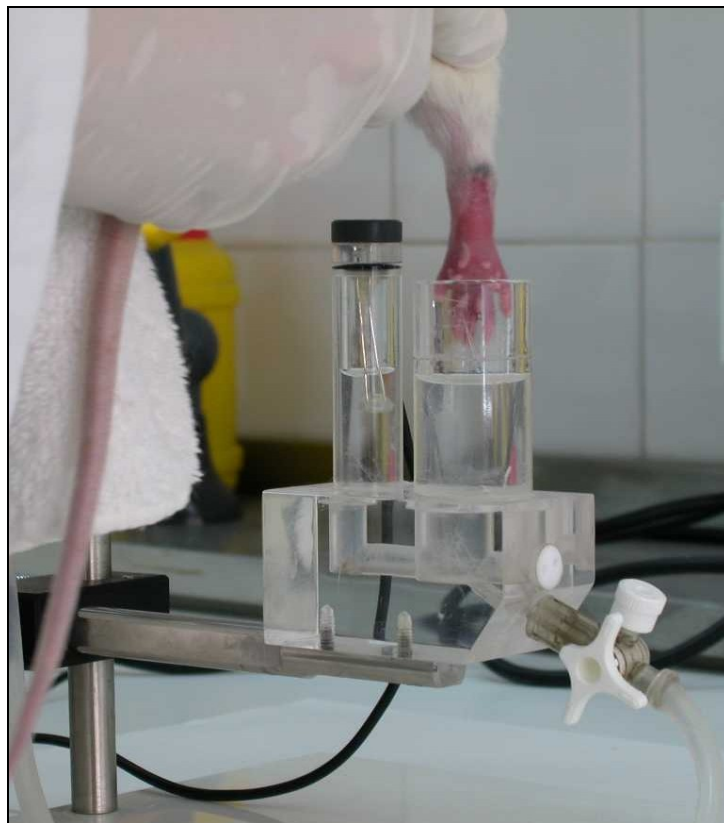
Figura M.5.- Medida del volumen de la pata por pletismometría (pletismómetro LETICA, Panlab).
