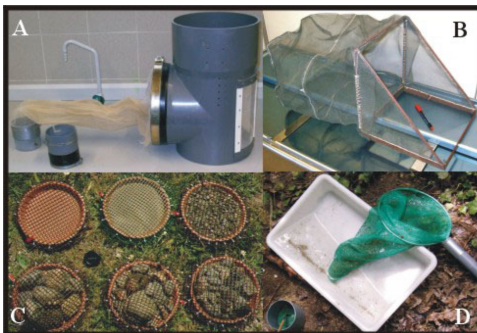
Figura 2. Se muestran cuatro métodos para la recolección de macroinvertebrados bentónicos en ríos: los muestreadores Hess (A) y Surber (B), varios tipos de substratos artificiales construidos con materiales naturales (C) y una manga o red de mano (D). Los tres primeros son métodos de muestreo cuantitativos en los que se puede cuantificar el número de ejemplares de cada especie por unidad de superficie, mientras que el último se emplea para conocer el número de especies presentes en un tramo fluvial. Fotos Álvaro Alonso.
