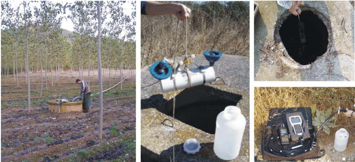
Muestreo del acuífero aluvial y determinación "in situ" de algunos parámetros físico-químicos
