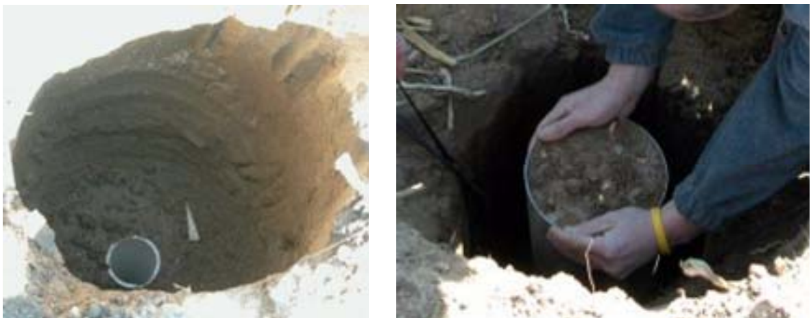
Detalle de la instalación del Lisímetro Capilar Pasivo de Gee mediante el método del monolito intacto en La Poveda (Parcela 1)
