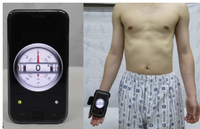
Fig. 2.46: Aplicación inclinómetro en un teléfono inteligente que es fijado a la muñeca mediante una banda. Tomado de Shin SH, Ro du H, Lee OS, Oh JH, Kim SH. Within-day reliability of shoulder range of motion measurement with a smartphone. Man Ther. 2012;17(4):298–304.
