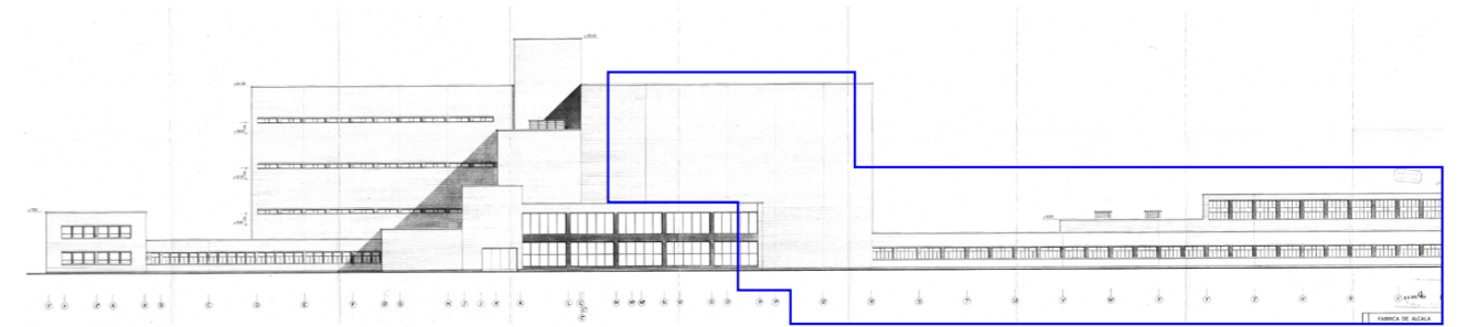
Fig. 140: Alzado norte del edificio principal, en azul resaltado la ampliación, escala 1:100 Fuente: Archivo Municipal de Alcalá de Henares. Leg 4744/1
