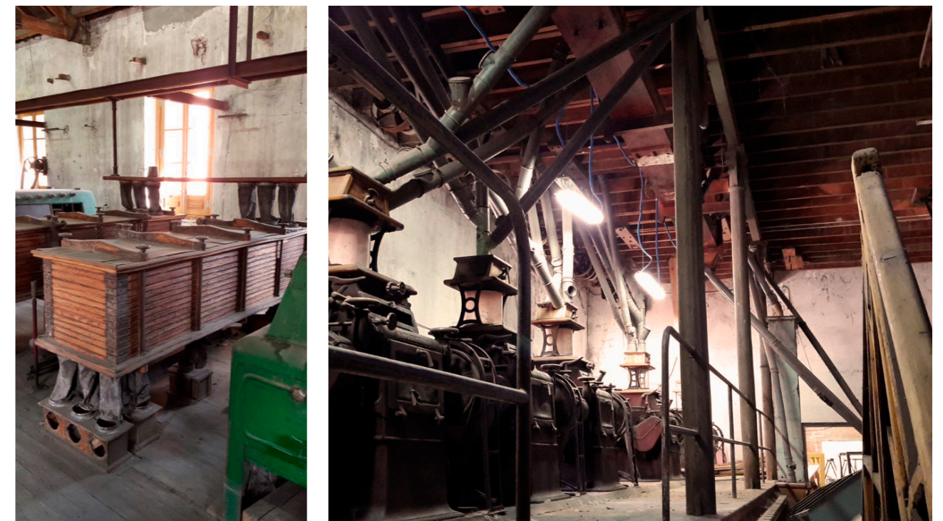
Fig. 56: Interior de la nave de molinos. (Izquierda) imagen de un plansichter doble de la marca Daverio para el tamizado o cernido en planta superior y, (derecha) molinos mecánicos del sistema austrohúngaro para la molienda de grano, en planta baja Fuente: Fotografías por Ángeles Layuno
