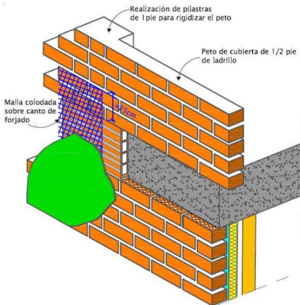
**DETALLE 10a** – Disposición del peto de cubierta con fábrica de ladrillo de 1/2 pie de espesor y montaje de malla en canto forjado
