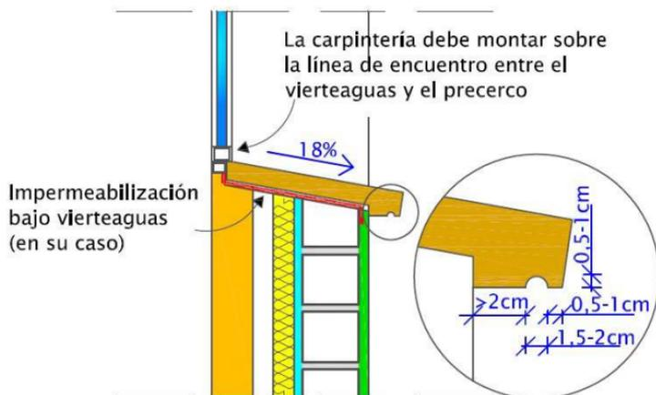
**DETALLE 6b** – Sección de fachada. Colocación de una viertega de piedra natural o artificial en hueco de ventana
