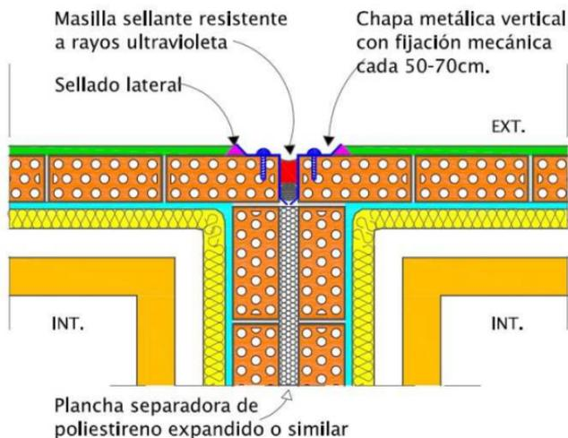
**DETALLE 9b** – Solución de junta de dilatación con inclusión de chapa metálica.
