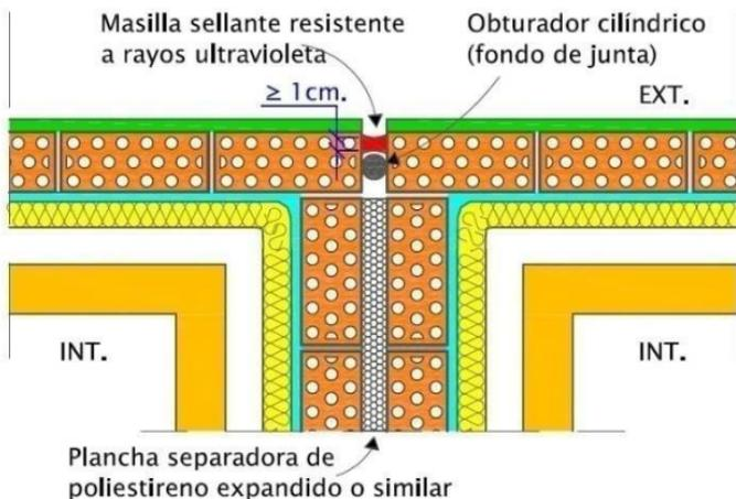
**DETALLE 9a** – Solución de junta de dilatación con formato estándar.
