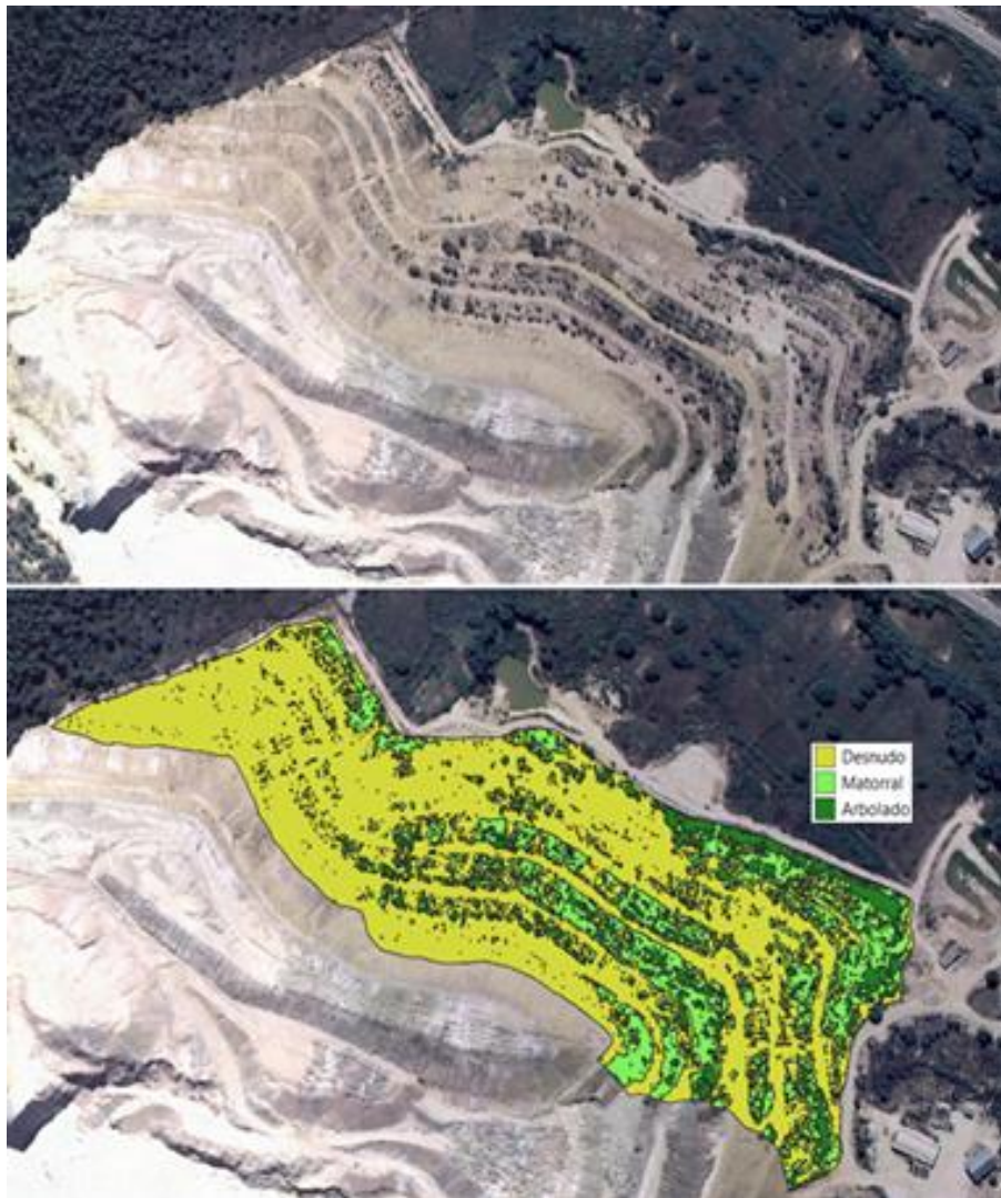
Figura 14: Panel superior: recorte de la ortofoto PNOA 2006 en la que se muestra el área de la escombrera de la mina M a José que se sectorizó. Panel inferior: resultado de la clasificación utilizando la herramienta dzetsaka. Fuente: Elaboración propia.
