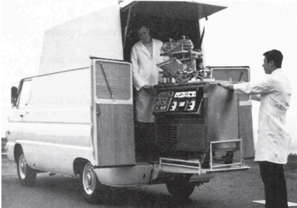
Figura 15: máquina de perfusión de Belzer transportada en una de las furgonetas que utilizaban para desplazar el órgano. Fuente: Stanford University, Transplant Department (<https://web.stanford.edu>)
