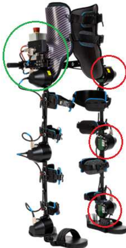
Figura 2. Exoesqueleto EXO-H3 de Technaid, con motores señalados en rojo y unidad de control central y batería en verde.
