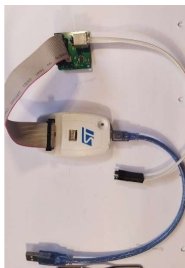
Figura 47.Placa de conversión con cables conectados y programador.
