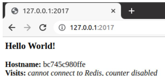
Figura 25: Comprobación con un navegador del servicio web alojado en el contenedor Docker con imagen friendlyhello descargada del repositorio
