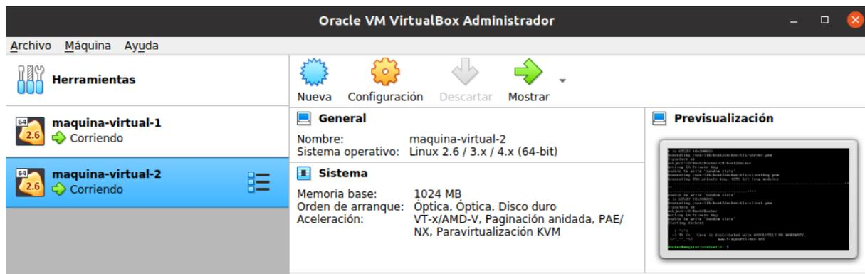
Figura 33: Muestra de las máquinas virtuales creadas con docker-machine en la interfaz visual de VirtualBox
