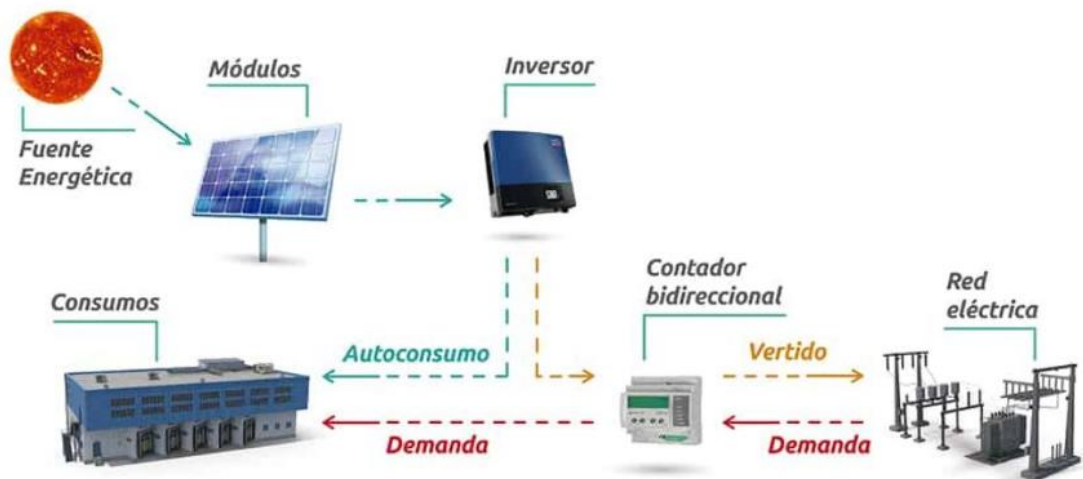
Figura 12: Instalación fotovoltaica conectada a la red eléctrica
