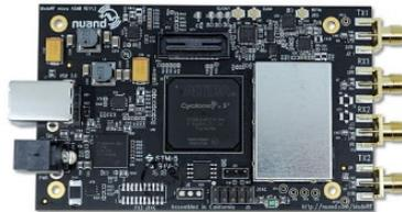
Figura 4: Ejemplo de dispositivo BladeRF
