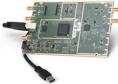
Figura 3: Ejemplo de dispositivo USRP
