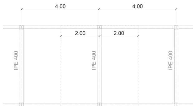
Área de carga viga
