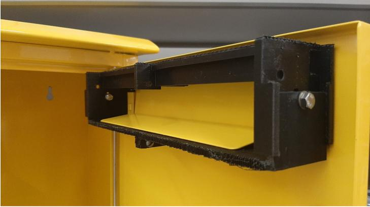
Figura 4.11: Pieza fija junto con la deslizadera
