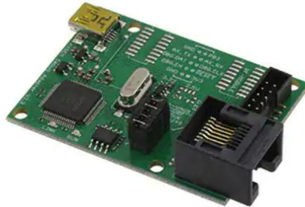
Figura 5.1: Tarjeta empleada para conectar el nodo mediante USB
