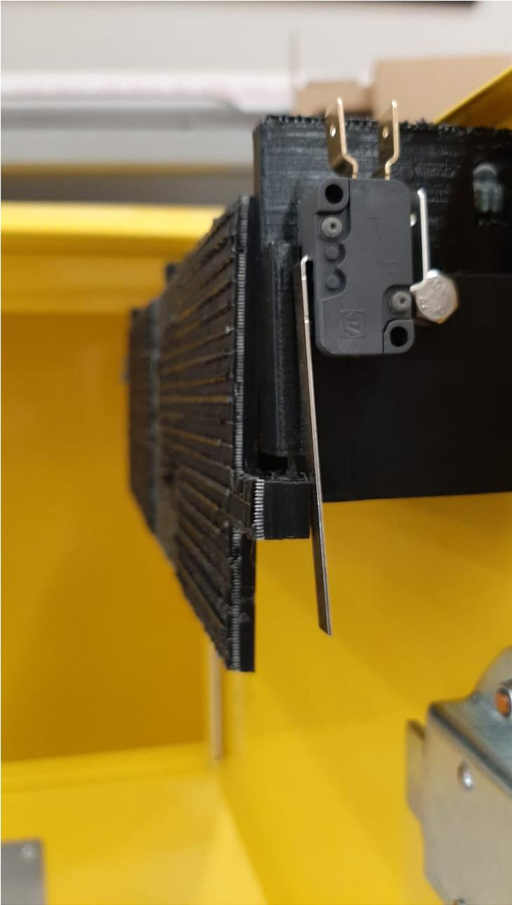
Figura 4.12: Sistema de detección de correo completo
