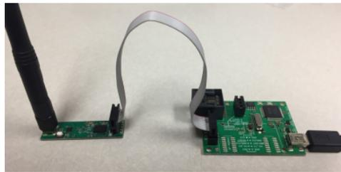
Figura 5.2: Conexión de los diferentes componentes necesaria para activar el nodo
