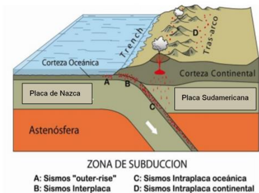
Fig. 2. Fuentes sismogénicas de la subducción chilena con las respectivas placas tectónicas (modificado de Centro Sismológico Nacional).
