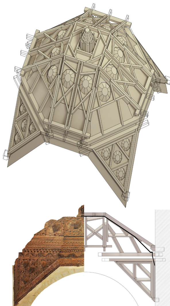
Figura 3. Artesonado de San Esteban (Villamayor de Campos). Arriba: Modelo digital del extradós. Abajo: Sección mixta del artesanado que muestra la relación entre el diseño del intradós (fotogrametría) y el modelo de la estructura.
