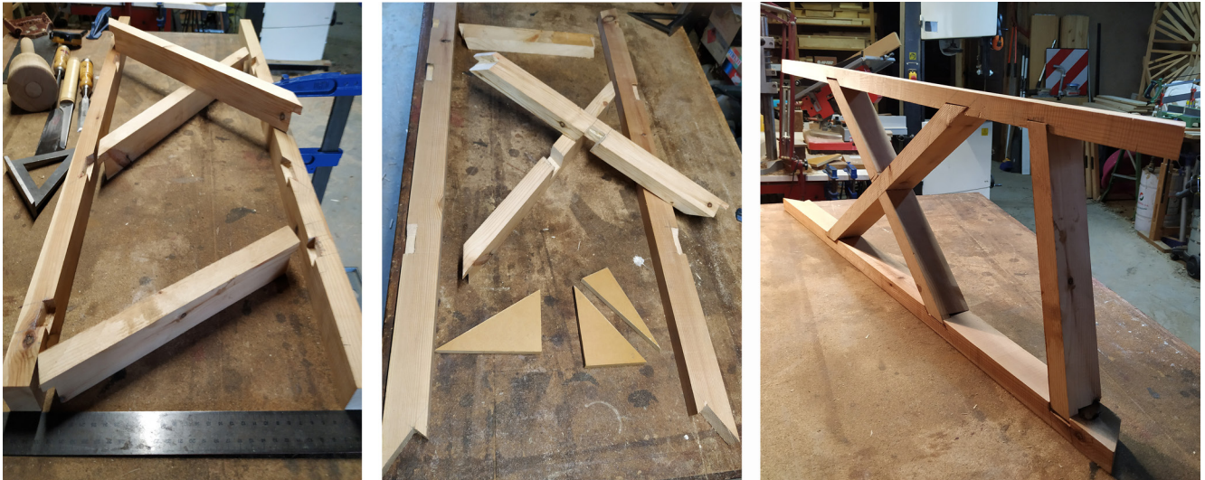
Figura 8. Maqueta a escala de la estructura utilizada a modo de parihuela fabricada en taller para facilitar el montaje del techo.
