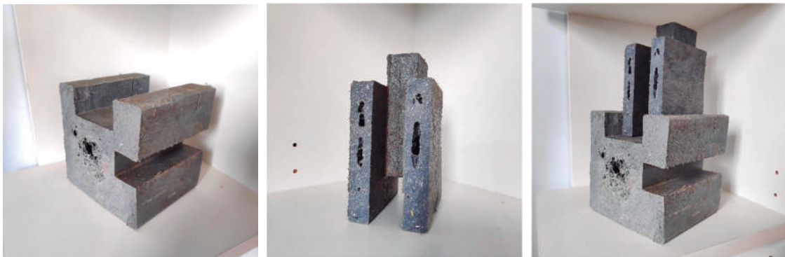
Imagen 1. Bloques arquitectónicos macizos de plástico reciclado. De izquierda a derecha: bloque estructural; bloque no estructural; ensamblaje ambas piezas. Fuente: elaboración propia
