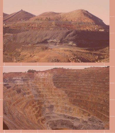
Se aprecia la alteración de colores según la roca, las oscuras son pizarra y rocas básicas, mientras que las claras son filitas.
