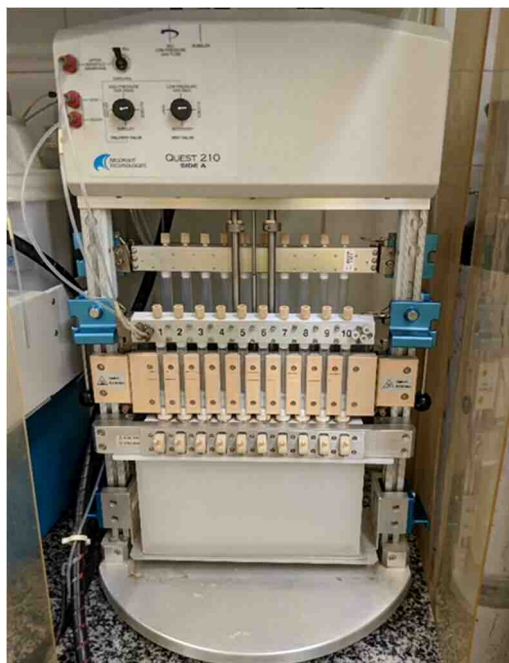
Figura 67. Dispositivo de síntesis en paralelo QUEST 210 de Argonaut®.
