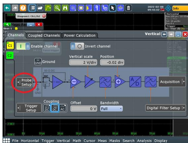
Figura 17: Posibilidad de configuración de sondas de medición utilizadas en el setup.
