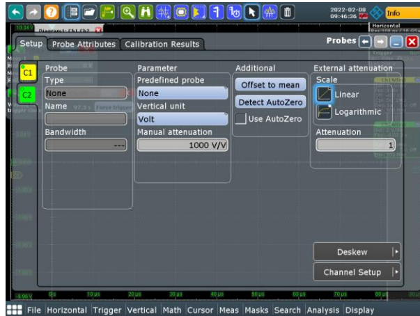
Figura 18: Posibilidad de configuración de los parámetros de las sondas utilizadas para que el osciloscopio lo tenga en cuenta.
