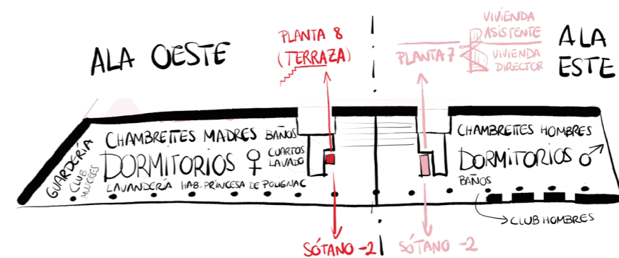
(Fig. 8) Diferenciación de usos según ala - oeste para mujeres y niños, este para hombres, director y asistente -. El ala oeste está mucho más cargado de usos y es, en consecuencia, más extenso. Las escaleras determinan la longitud de cada ala. Diagrama de elaboración propia.
