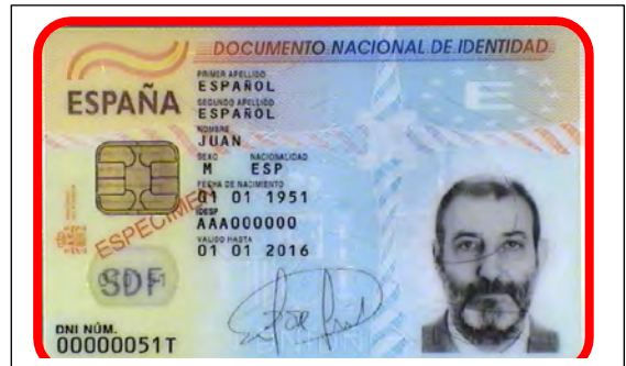
Figura 28. Sustrato del Documento Nacional de Identidad de España 2.0 realizado en policarbonato.
