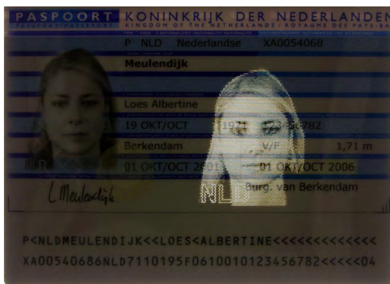
Figura 14. Imagen secundaria realizada con láser de quemado que aparece en la página biográfica de un pasaporte de Holanda.
