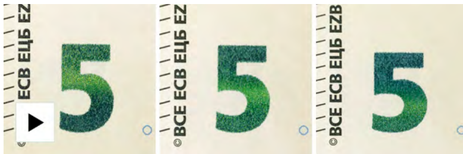
Figura 32. Tintas spark incorporadas en los billetes de la serie Europa del euro.
