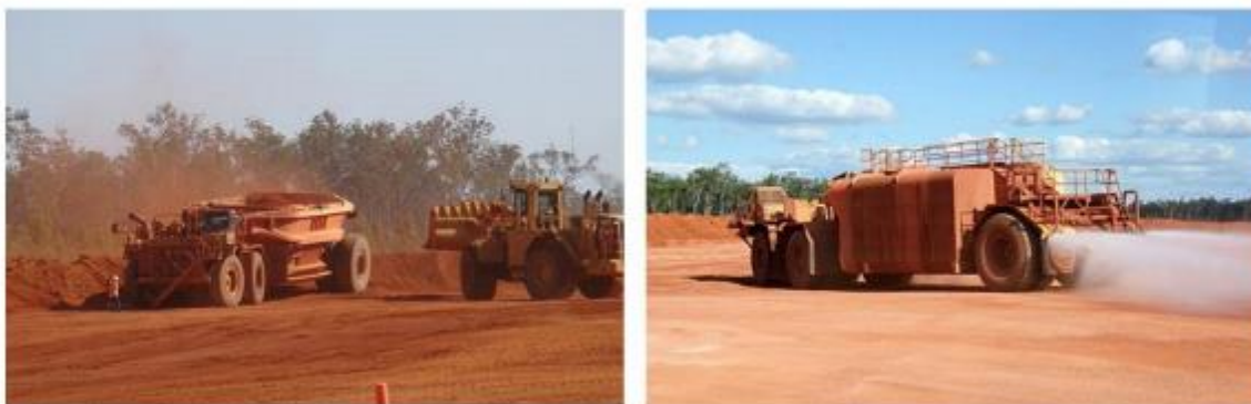
Figura 21. Imágenes de la mina Wiepa en Australia mostrando procesos de compactación y aspersión periódica debido a la intensa actividad y tránsito de equipo pesado.
