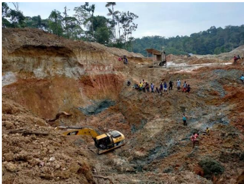
Figura 10. Deslizamientos de tierra por actividad minera ilegal en la provincia de Esmeraldas – Ecuador.
