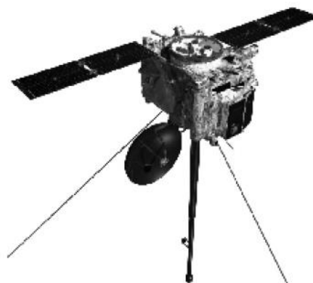
Figura 4. 9: Uno de los dos satélites idénticos STEREO [35].
