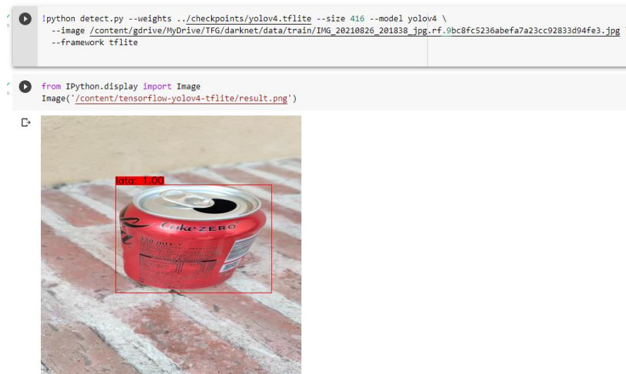
Ilustración 26 Prueba de detección con el modelo entrenado en Google Colab
