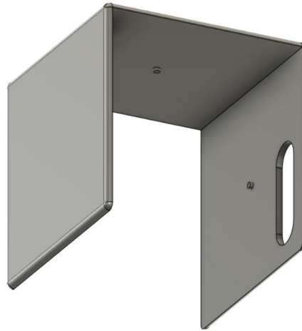
Figura 77. Vista interior de la carcasa de los SmartCubes (salientes de las caras)
