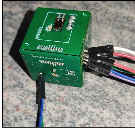
Figura 91. SmartCube con los orificios de alimentación y programación soldados
