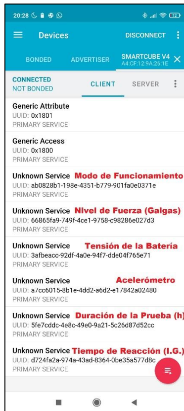
Figura 94. Servicios BLE (prueba final SmartCube)
