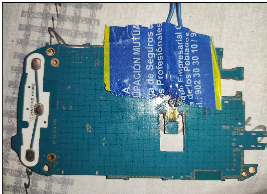
Figura 22. Entorno de prueba de la galga (PCB de un smartphone)
