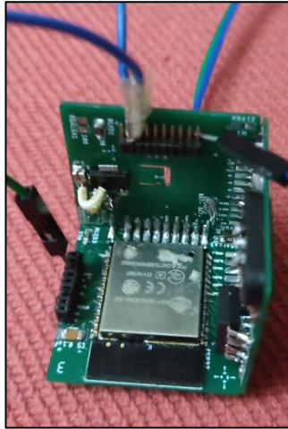
Figura 93. Mitad 1 del SmartCube conectada al circuito de auto programación externo
