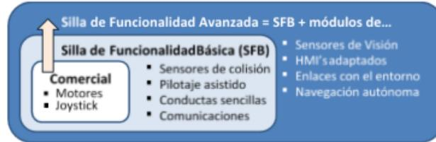
Figura 1.1: Esquema funcional de la silla de ruedas
