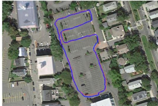
Figura 3.7: Estimación de la posición empleando odometría, dos IMU y un GPS [7]
