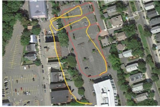
Figura 3.6: Estimación de la posición empleando odometría y dos IMU [7]
