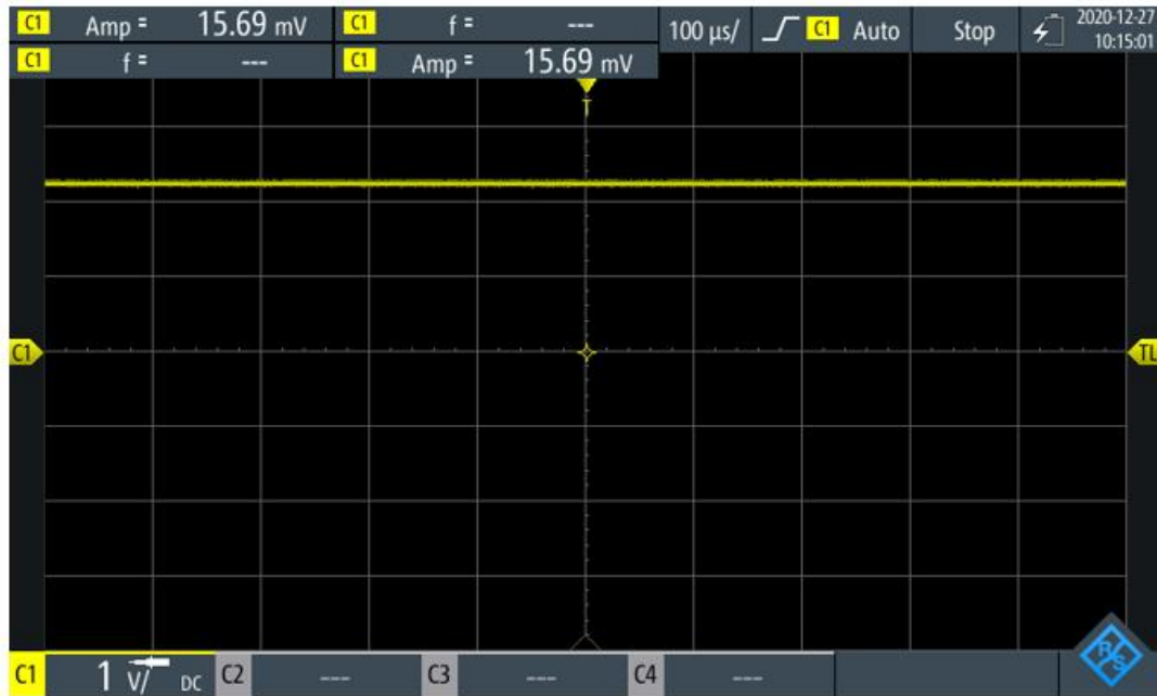
Figura 4.8 Medición de la tensión a circuito abierto de la célula solar con 15 lx
