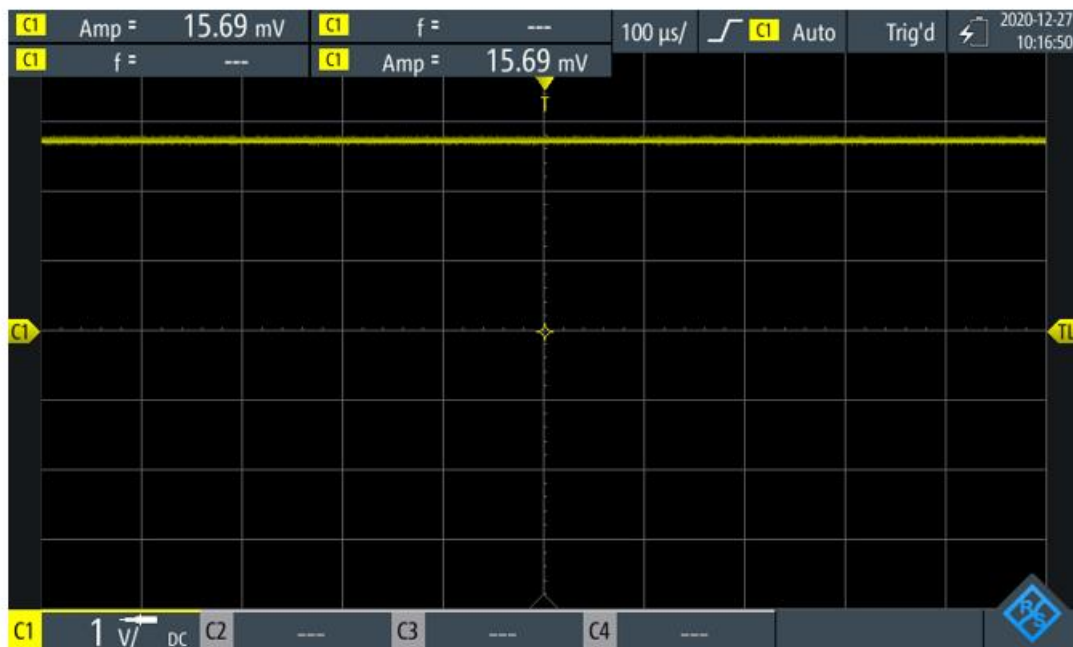
Figura 4.9 Medición de la tensión a circuito abierto de la célula solar con 260 lx
