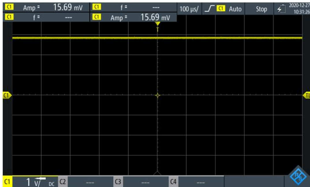
Figura 4.10 Medición de la tensión a circuito abierto de la célula solar con 443 lx
