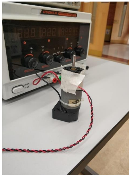
Figura 4.2 Piezoeléctrico tipo lámina acoplado al motor
