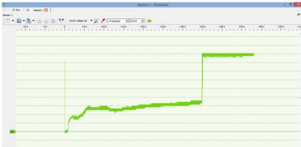
Figura 4.15 Medición de la tensión de salida fija de 4.2 V del circuito de carga B
