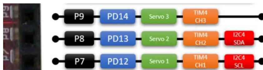
Figura 22. Pines para control de servomotor [1]
