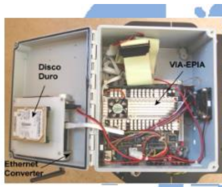
Figura 11: Disposición de la Vía-Epia, Disco Duro y Ethernet Converter dentro de la caja del robot
