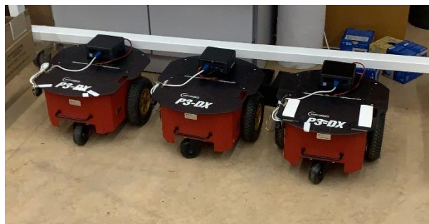
Figura 17: Sistema físico completo con miniPC en la plataforma robótica P3-DX
