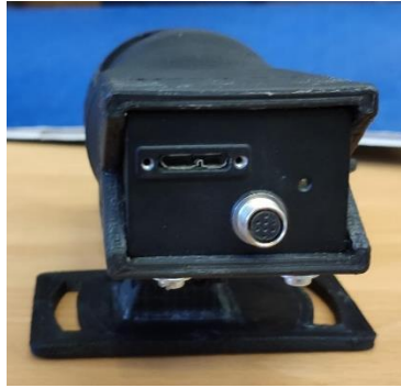
Ilustración 11. Vista trasera de la cámara del grupo INVETT donde se aprecia el conector de 8 pines.
