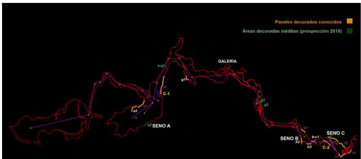
Fig. 1: Planta de la cueva de Los Casares con indicación del replanteamiento de la poligonal de origen (línea morada), sondeos arqueológicos (C-1, C-2) y paneles decorados.
