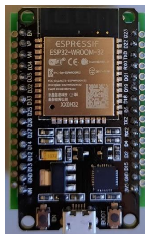
Figura 39. Montaje PCB & ESP32.
