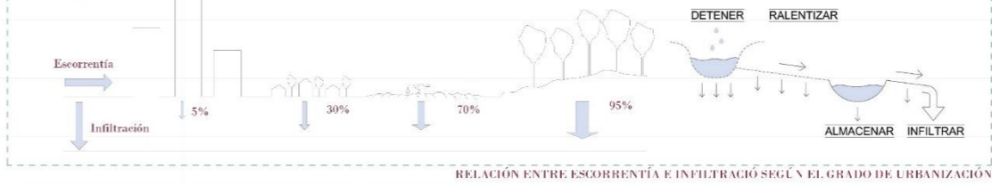
RELACION ENTRE ESCORRENTÍA E INFILTRACIÓN SEGÚN EL GRADO DE URBANIZACIÓN
