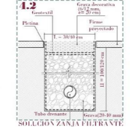
SOLUCIÓN ZANJA FILTRANTE
