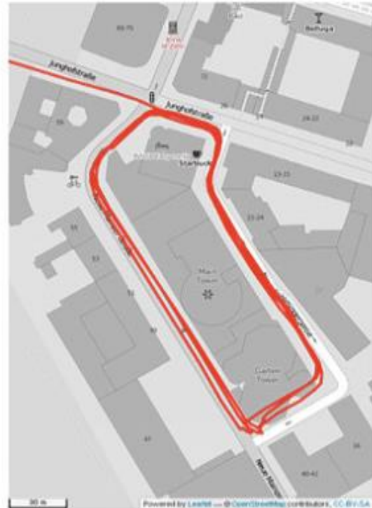
FIGURA 6.2 Comparativa de precisión con sistema sólo GNSS y con UDR. Fuente [23].
