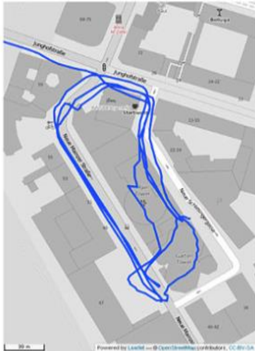
FIGURA 6.2 Comparativa de precisión con sistema sólo GNSS y con UDR. Fuente [23].
