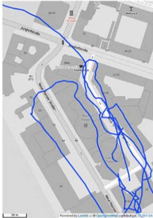
FIGURA 6.3 Comparativa de precisión entre sólo GNSS y UDR con señal atenuada. Fuente [23].
