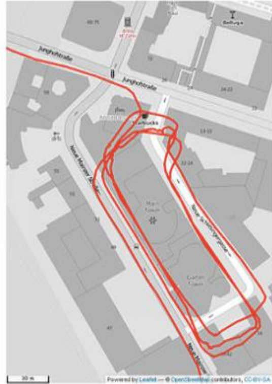
FIGURA 6.3 Comparativa de precisión entre sólo GNSS y UDR con señal atenuada. Fuente [23].
