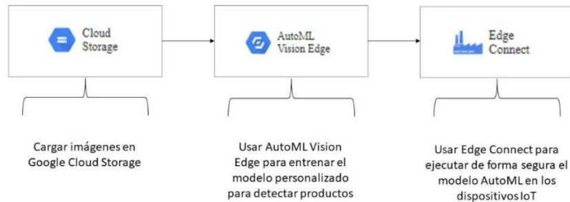
Figura 2-4: Funcionamiento de Google Vision AI en dispositivos IoT. [17]
