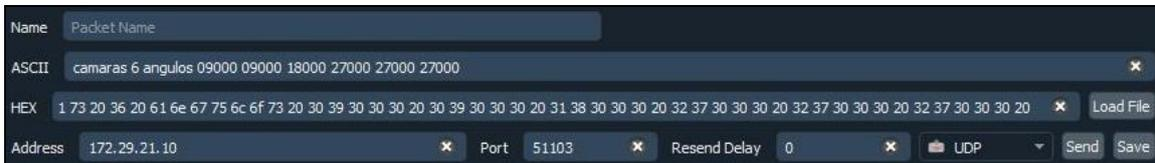
Figura 83. Ejemplo de envío de paquete de configuración a través de Packet Sender.
