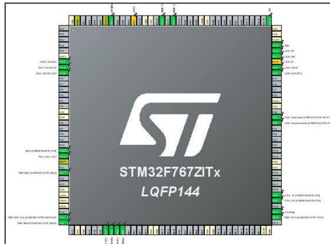
**Figura 15. Microcontrolador inicializado por defecto en STM32CubeMX.**
