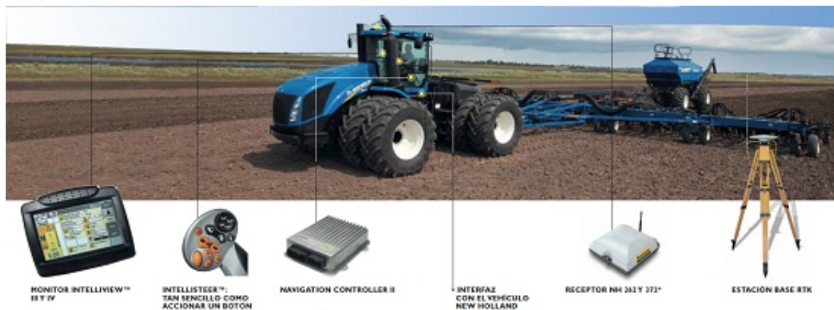
Figura 5.5: Sistema de guiado de un tractor de la empresa GPS New Holland AG .
