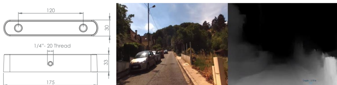
Ilustración 26 Formato de cámara ZED, visión RGB y mapa de profundidad
