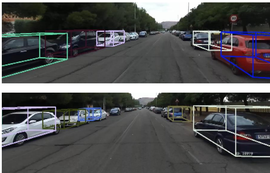
Ilustración 46 Detección y seguimiento en Techs4AgeCar en t , t+20 frames. Sensor RGB
