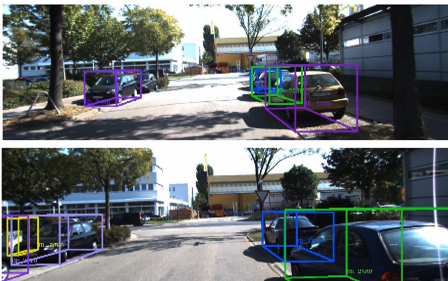
Ilustración 38 Detección y seguimiento en dataset KITTI en t , t+20 frames. Sensor RGB
