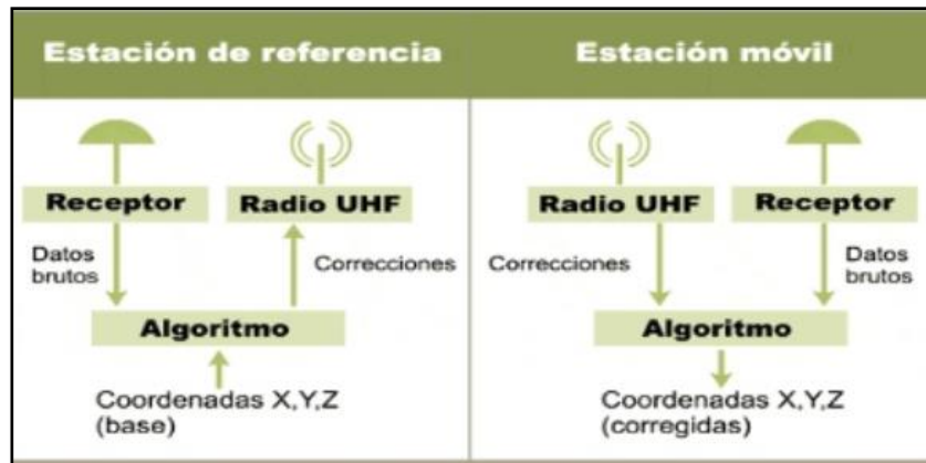
Figura 3.9 - Estructura general del GPS Diferencial [26]
