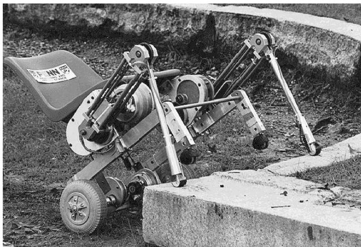
Figura 2-2: El prototipo de la Universidad de Pennsylvania escalando un obstáculo.
