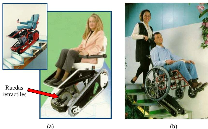
Figura 2-4: Subir y bajar escaleras: (a) Banda rodante integrada en la silla *Explorer*, de la firma italiana TGR; (b) Accesorio independiente, también basado en banda dentada, para sillas de ruedas manuales.
