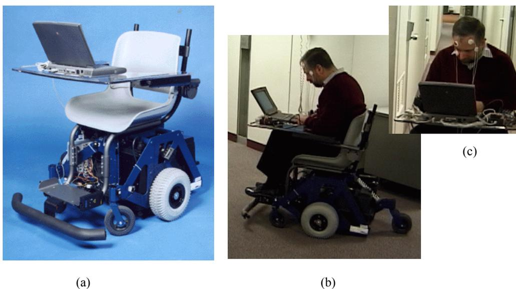
Figura 2-13: La silla *Wheelesley*: (a) Vista general. (b) Guiado por Electro-Oculografía (EOG). (c) Un detalle de los sensores EOG.
