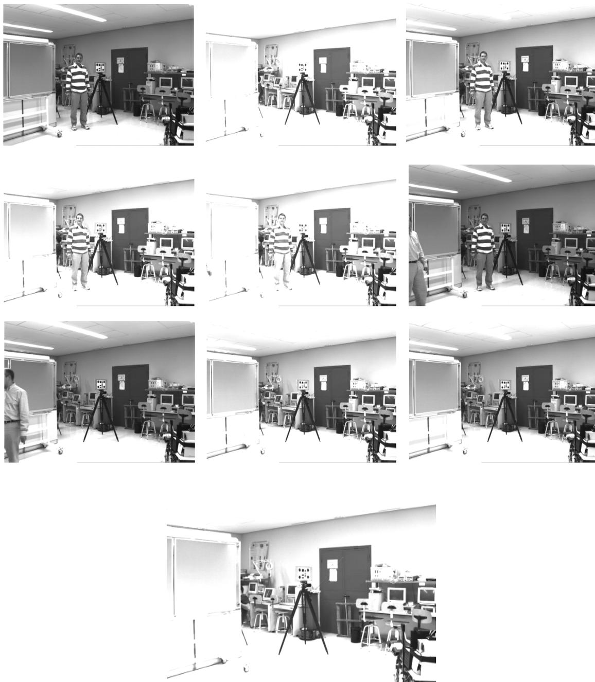
Figura 4-26: Batería de 10 imágenes correspondientes al punto  $P_{5-45}$ : distancia 5 m, desviación angular  $\phi = 45^\circ$ . Se muestran aquí las diversas condiciones de luminosidad y las características del entorno de prueba, con las numerosas fuentes de ruido de imagen existentes.
