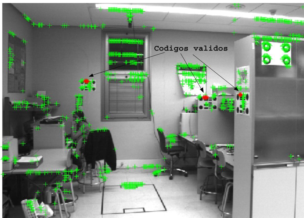
Figura 4-16: Puntos de búsqueda de códigos Barker-7 en una imagen real.
