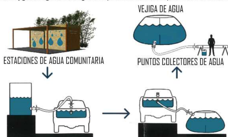
Figura 77: Funcionamiento de las estaciones de agua
