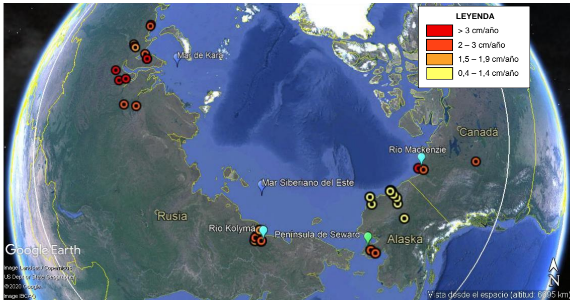
Figura 9. Estaciones CALM con las mayores y menores velocidades de cambio de espesor de capa activa durante el periodo 1994-2017.
