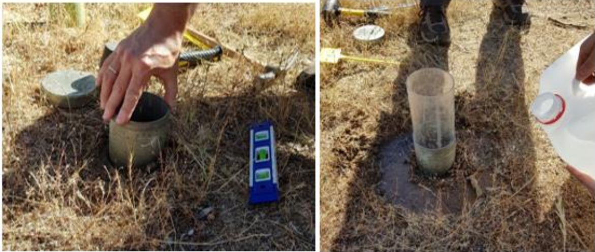
Figura 9. Cilindro metálico introducido en el suelo (izq.); Surco con agua alrededor del infiltrómetro (dcha.)
