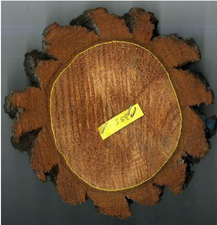
Figura 4: la línea amarilla es la circunferencia realizada para medir el área y el perímetro del xilema.
